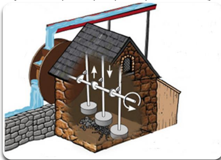
Rys. A.2 Przykład zastosowania koła wodnego do napędu stempli kruszących rudę, źródło fundacjaenergia.pl
