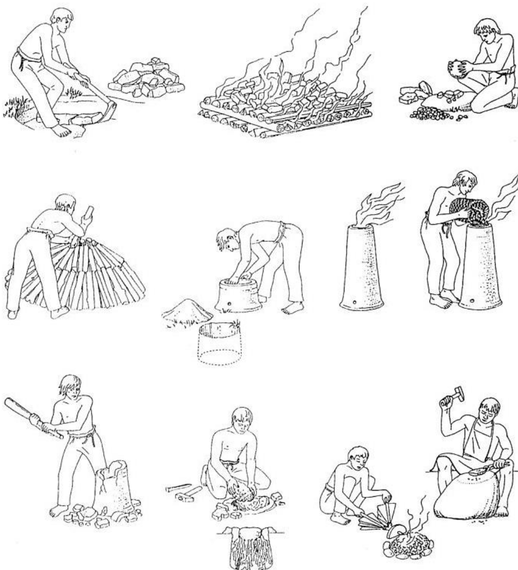
Rys. 1.3. Proces dymarski – pozyskiwanie żelaza w piecu kotlinkowym, źródło: Internet, strona Dymarek Świętokrzyskich
