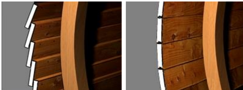
Rys. 7.3. Zakładkowe poszycie kadłuba statku (zasada)
