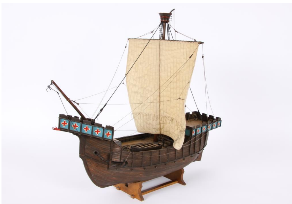
Fot. 7.2. Model hulki z około 1400 roku z Narodowego Muzeum Morskiego w Gdańsku. Ożaglowanie – rejowe – stanowi prostokątny żagiel zawieszony na poziomym poprzeczce masztu – rei. W ożaglowaniu łaciński reja jest umocowana ukośnie, a żagiel ma kształt trójkąta
