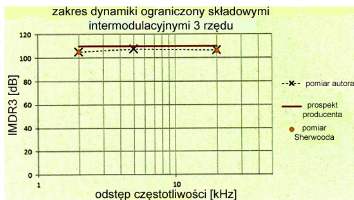
Rys. 1.3. Pomiary zakresu dynamiki ograniczonego składowymi intermodulacyjnymi wykazują daleko idącą zgodność
