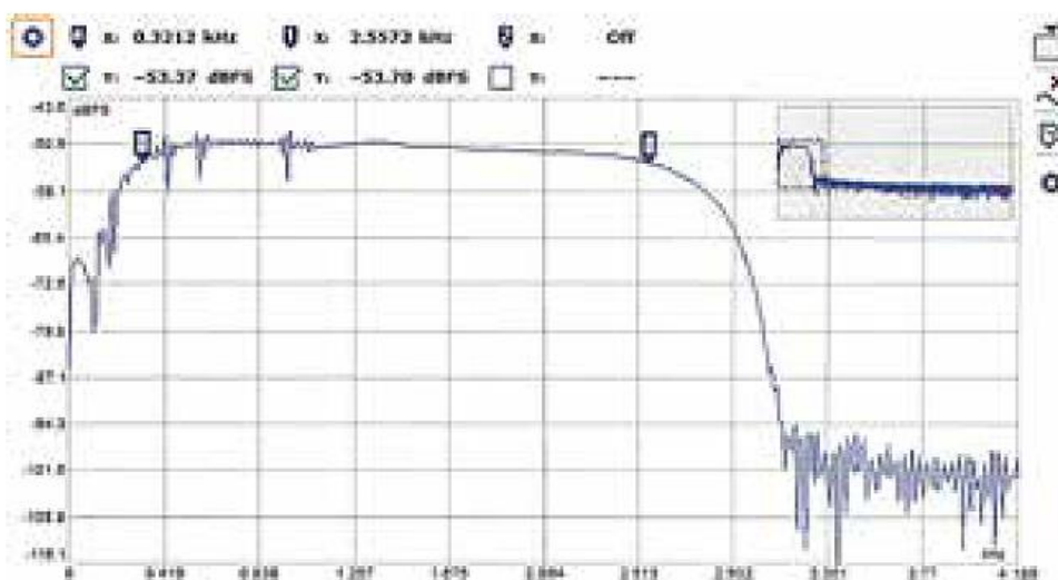
Rys. 13. Charakterystyka częstotliwościowa nadajnika
