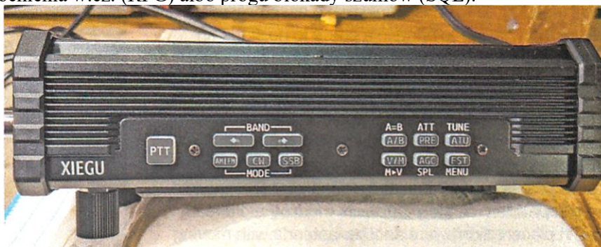
Fot. 8.4. Klawisze na górnej ścianie. Sześć klawiszy po prawej stronie ma przypisane po dwie funkcje. Są one podpisane odpowiednio na klawiszach i obok nich
