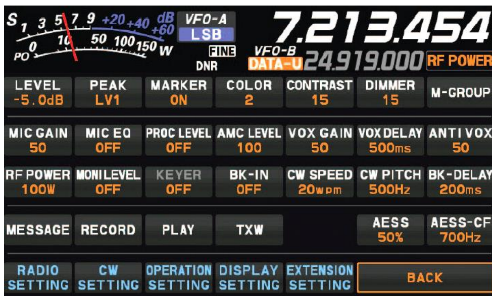
Fot. 3.3. Naciśnięcie punktu na ekranie pozwala na wybór ustawienia za pomocą gałki funkcyjnej. W przykładzie widocznym na ilustracji wybrany jest punkt RF POWER (moc w.cz.). Na dole w kolorze niebieskim wyświetlone są wywołania rzadziej używanych punktów menu
