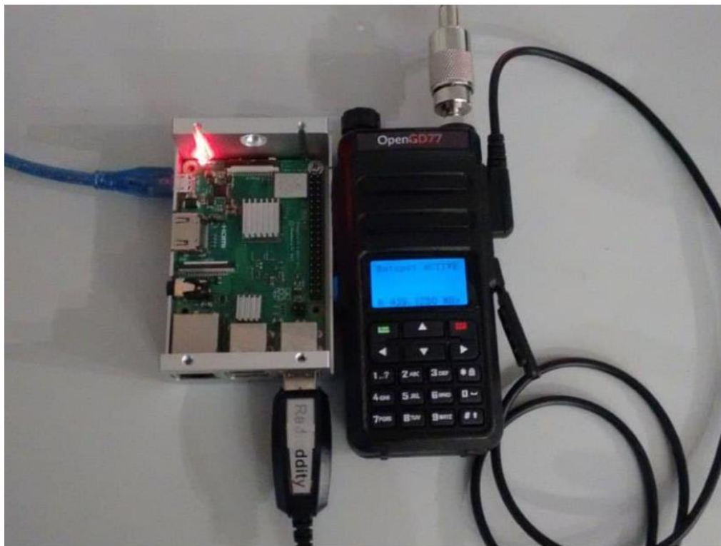
Rys. 1.17.1. Połączenie elementów mikroprzeziennika – radiostacji z mikrokomputerem za pomocą kabla USB i anteny zewnętrznej przez odpowiednią przejściówkę.
