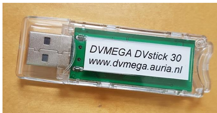
Fot. 3.3. Wokoder AMBE USB konstrukcji PE1PLM (źródło www.pa7lim.nl )
