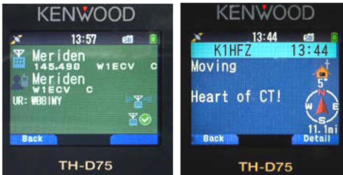
Rys. 4.1. Wyświetlacz po połączeniu z najbliższym przemiennikiem D-Starowym. Dzięki zapisaniu w pamięci spisu przemienników znalezienie najbliższego to sprawa kilku sekund
