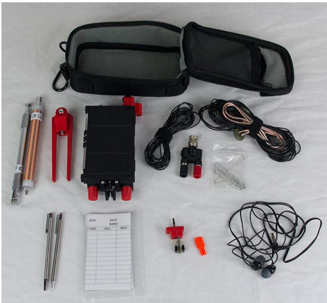
Fot. 8.5. KH1 z akcesoriami do pracy terenowej. Etui typu ES20, pozostałe elementy z zestawu KH1 Micro Travel Kit
