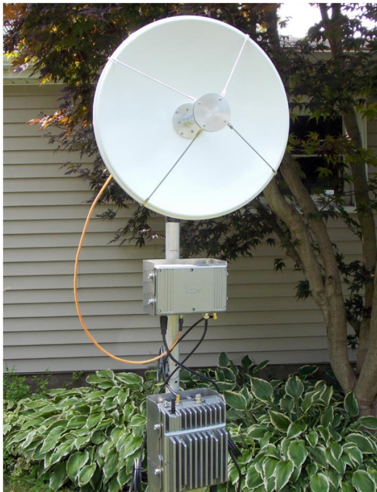
Fot. 3.1. U dołu masztu znajduje się moduł radiowy dla pasm 2 m – 6 cm, a na nim umieszczony jest moduł transwertera na pasmo 10 GHz. Na szczycie masztu znajduje się antena paraboliczna AH-109PB na 10 GHz. Maszt i trójnóg nie należą do kompletu
