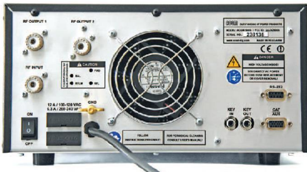
Fot. 10.4. Na tylnej ściance widzimy wentylator chłodzący, wyłącznik a także gniazda wejści-i wyjść
