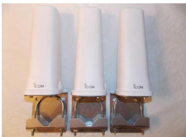
Fot. 3.7. Trzy dookólne anteny Icoma o małym zysku na pasma 2,4, 5,6 i 10 GHz. Mają one polaryzację pionową
