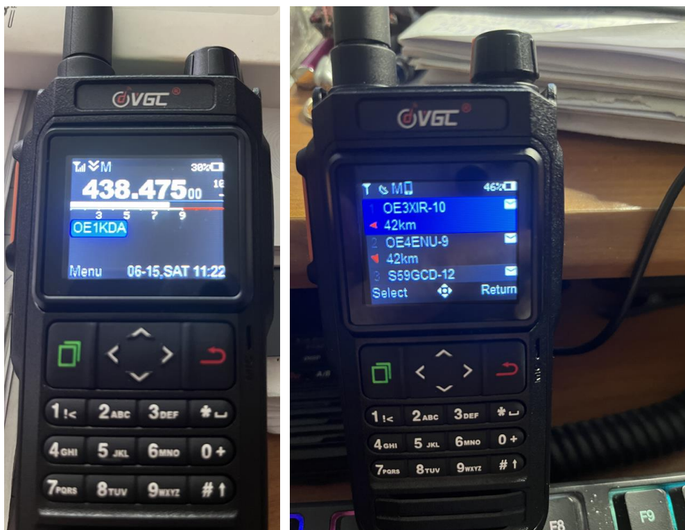
Fot. 1.1. Przy prawidłowym odbiorze satelitów GPS wyświetlane są data i czas
