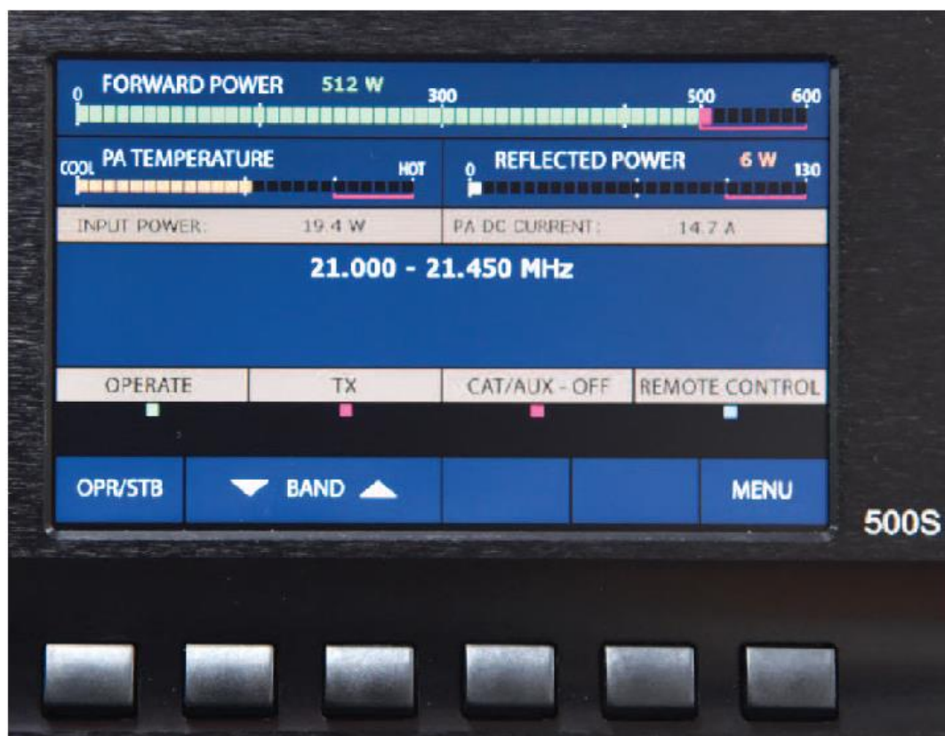
Fot. 10.1. Na ekranie wyświetlone są najważniejsze parametry robocze jak wybrane pasmo, moc padająca i odbita, wysterowanie i temperatura stopnia mocy. Nie jest to ekran dotykowy więc do przełączania funkcji służą umieszczone pod nim klawisze. Są one podpisane na ekranie, a ich funkcja zmienia się zależnie od kontekstu. Klawisz MENU otwiera okno menu konfiguracyjnego
