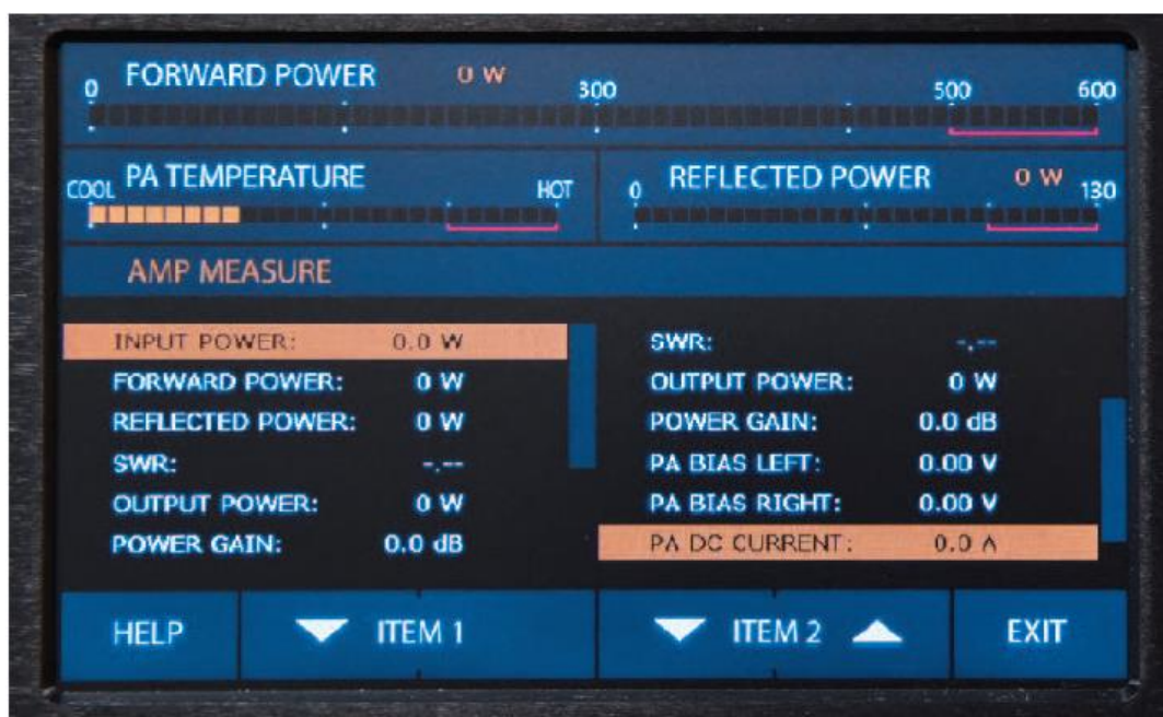
Fot. 10.3. Okno wielkości pomiarowych pozwala na wybór parametrów wyświetlanych w oknie głównym
